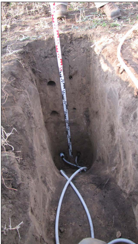
Слева: Установка постоянной почвенно-влажномерной станцией, Справо: Метеостанция в Полюямках
