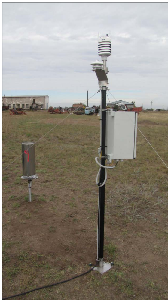
Слева: Установка постоянной почвенно-влажномерной станцией, Справо: Метеостанция в Полюямках
